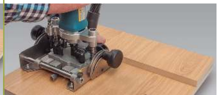
Фрезерування під кутом 0°
