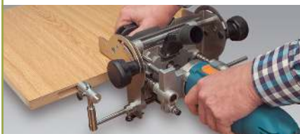
Фрезерування під кутом 90°
