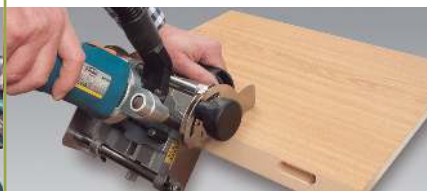
Фрезерування під кутом 45°
