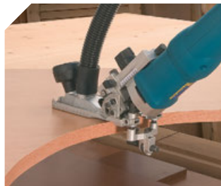
Kopiarka z łożyskiem kulowym. Idealne prowadzenie na zakrzywionych powierzchniach.
