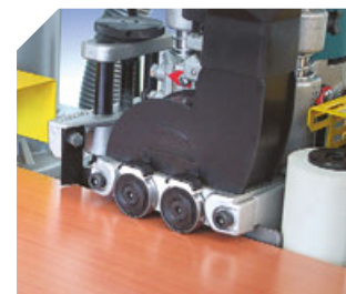
Jednoczesne frezowanie z góry i z dołu- zaokrąglanie lub fazowanie krawędzi obrzeża.
