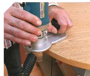
Głowica frezująca CA56U umożliwia ciągłą pracę na wszystkich krawędziach panelu, również zaokrąglonych.
