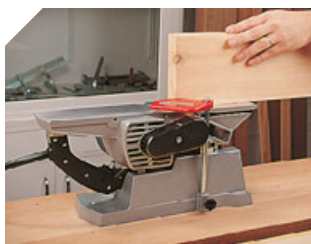
Stojak pozwalający na pracę w pozycji stacjonarnej
