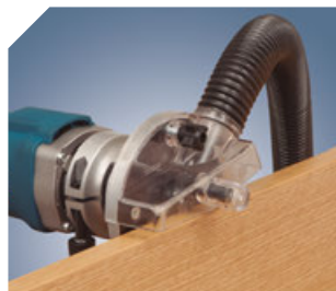
Obróbka krawędzi panelu z frezem promieniowym lub fazującym.
