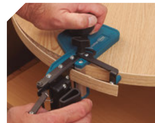
Docinanie obrzeża przy oklejaniu elementów krzywoliniowych.
