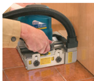
Głębokość cięcia pozwala na jednorazowe przycięcie drzwi bez odprysków.
