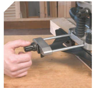
Przymiar boczny z mikrometryczną regulacją.
