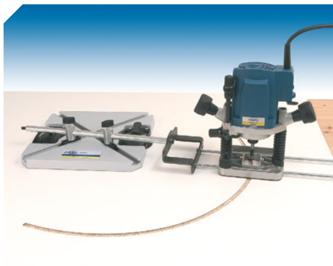
Mocowanie za pomocą przysawek próżniowych (w zestawie) i śrub.
