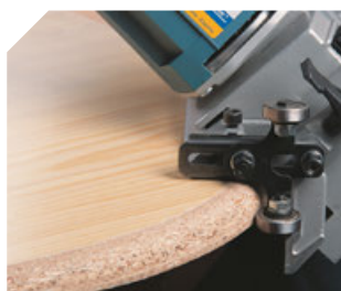
Zaokrąglenie lub cięcie krawędzi po promieniu R=5, R=10 lub R=15 przy użyciu kopiału oraz dodatkowego ostrza nr 9841005.
