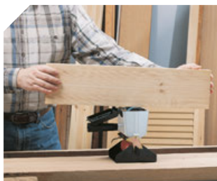
Nakładanie kleju za pomocą wałka górnego.
