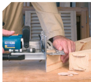
Spojenia ościeżnic z lamelką 6.
