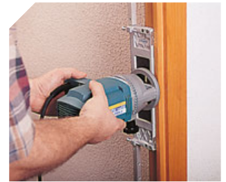
Montaż zawiasów z głowicą CPN66.
