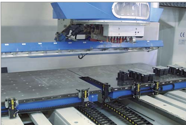
Innospann Steel-Plate-T | Модернізація гладкого столу з використанням Steel-Plate-T, Quad-Base і різних блокових присосок
