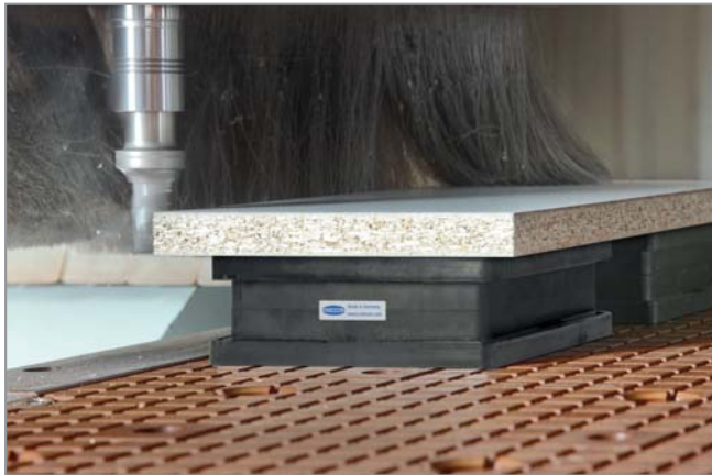
Блокова присоска VCBL-R для складної п'ятиосьової обробки
