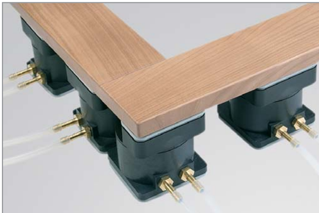
Блокові присоски Innosrapp на гладкому столі для фіксації рамки
