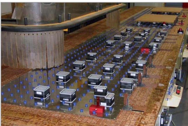
Innospann Steel-Plate | Модернізація матричного столу з використанням Steel-Plate, Mono-Base і різних блокових присосок
