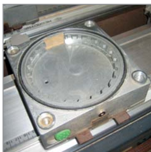
Всі типи блокових присосок VC-B (ст. 32 - 34) підходять для оригінального посадкового місця
