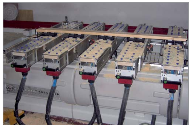
Innospann Steel-Plate | Модернізація консольного столу з використанням Steel-Plate, Mono-Base і різних блокових присосок
