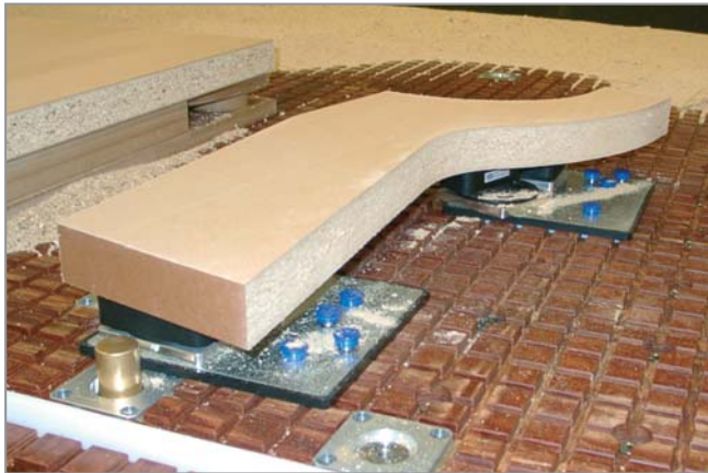
Блокові присоски Innosprann вільно позиціонуються на Mini-Plate ISMP-R
