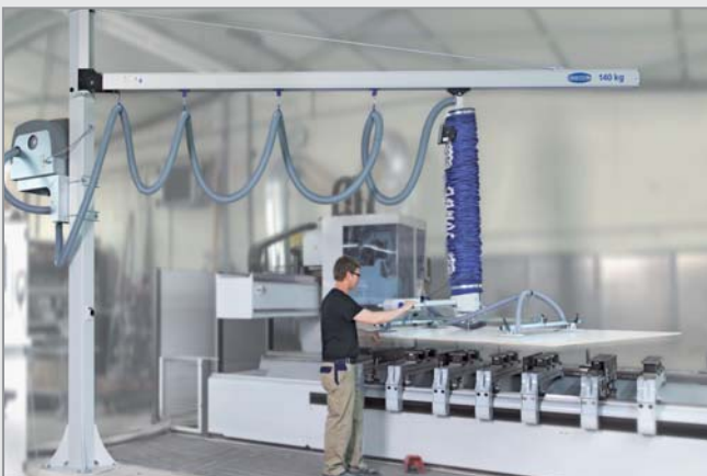
Комплексна система завантаження складається з вакуумного шлангового підійомника Jumbo і консольного крана
