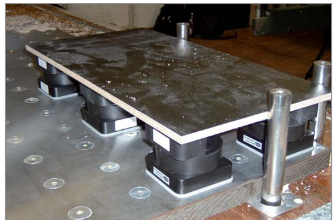
Innospann Steel-Plate-T | Модернізація гладкого столу з використанням Steel-Plate-T, Mono-Base і присосок, фіксація на проміжній плиті
